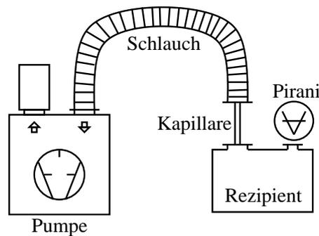
Abbildung 3: Aufbau zur Messung der Auspumpzeit
