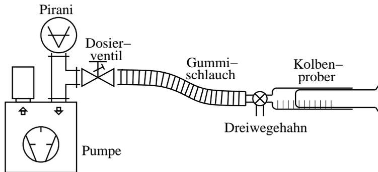
Abbildung 4: Aufbau zur Messung des Saugvermögens
